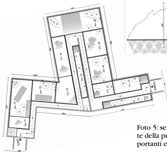
Foto 4: planimetria di grotta: in evidenza la suddivisione degli spazi interni e la dislocazione dei camini che forniscono luce e ricambio d'aria.
